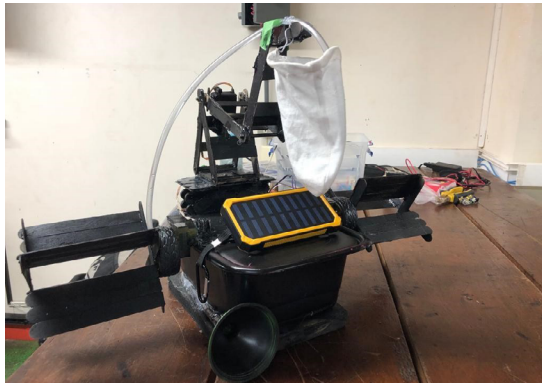
Figura 3. Prototipo Sistema autónomo de recolección de desechos sólidos en el estero puntarenense.
