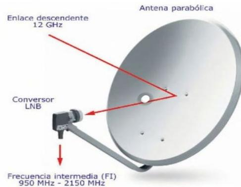
Cabe destacar que el LNB es un dispositivo que se sitúa en el foco de la antena parabólica y es el encargado de adaptar la señal recibida del satélite y distribuirla, mediante cable coaxial, a toda la instalación. LNB, que significa "Low Noise Block Downconverter", es un dispositivo utilizado en sistemas de recepción de señales de satélite, especialmente, en sistemas de televisión por satélite. Aquí hay una explicación más detallada de lo que implica cada parte del término:
