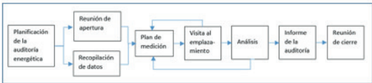
Figura 2. Diagrama de flujo del proceso de auditoría energética. Fuente: ISO 50002 (2018).
